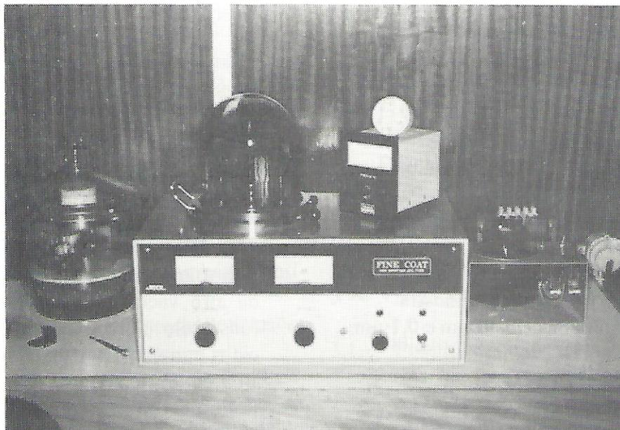
Fig. 4 — Sistema para obtenção de alto-vácuo.
