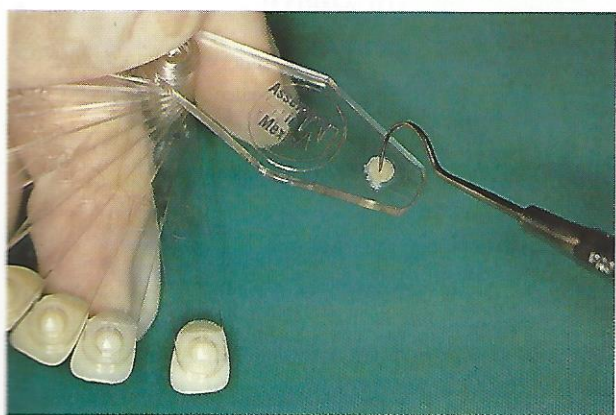
Fig. 4 — Avaliação com sonda da dureza do compósito à superfície e na base.
