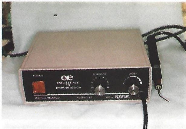
Fig. 2 – Aparelho de ultrasons piezoeléctrico, específico para endodontia, da casa Excellence in Endodontics/Spartan
