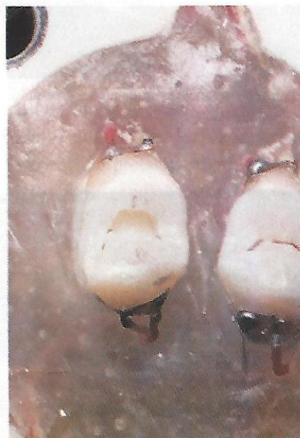
**Fig. 5** – Dentes incluídos em resina acrílica no anel de nylon, com os "strain gauges" acoplados. O dente testado apresenta uma cavidade oclusal. O dente controlo está intacto.
