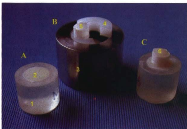
Figura 1 – Sequência laboratorial [A – Espécime com compósito envelhecido (1- cilindro em polimetacrilato de metilo autopolimerizável; 2- disco de compósito envelhecido durante um período de dois anos); B – Matriz utilizada (3- molde de aço; 4- anel de teflon; 5- cápsula de gelatina); C – Espécime com compósito reparado (6- incremento de compósito polimerizado sobre o compósito envelhecido)].
