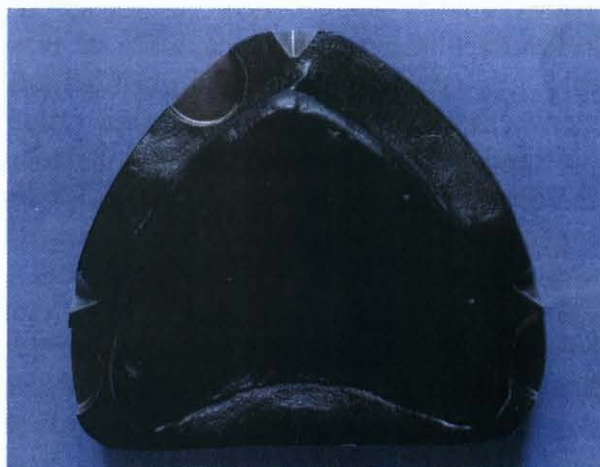
Fig. 1 – Modelo-mestre com as caixas e entalhes maquinados na área periférica.
