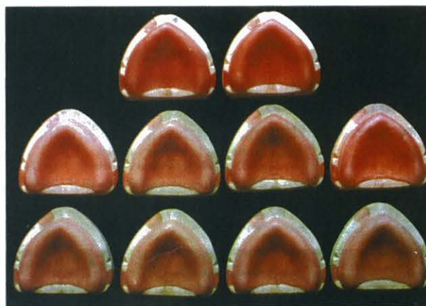
Fig.3 –Conjunto de 10 espécimes para uma técnica de processamento/polimerização - 10 modelos idênticos de gesso com as placas-base idênticas em cera.
