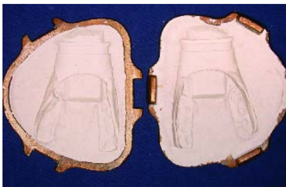
Figura 12 - Vista superior do molde e contra molde concluídos
