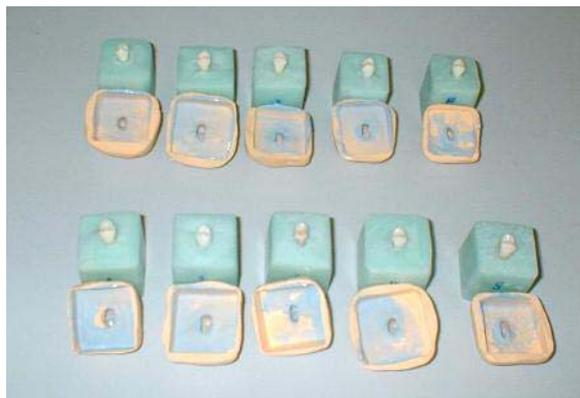
Figura 2 - Conjunto de dentes após impressão com silicone
