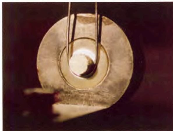
Figura 2 – Teste resistência adesiva sob tensões de corte do espécime reparado.
