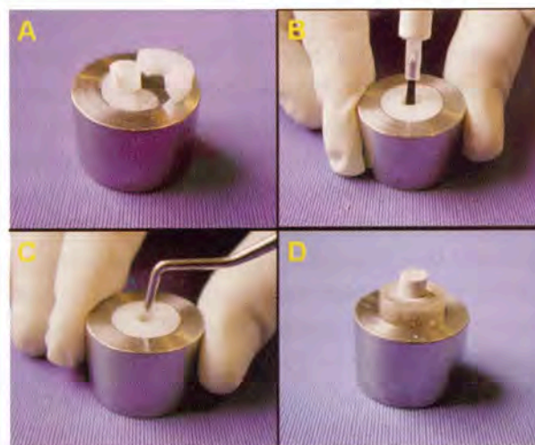
Figura 1 - Sequência laboratorial [A – Amálgama envelhecido colocado no interior de um molde de aço e matriz utilizada para a reparação dos espécimes (anel de teflon e cápsula de gelatina); B – Aplicação dos sistemas adesivos; C – Condensação do novo incremento de amálgama; D – Espécime com amálgama reparado].
