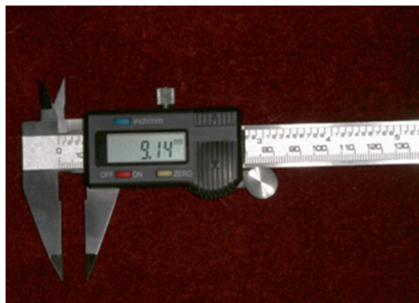
Figura 1 – Calibrador com escala Vernier com uma precisão de 0,01 mm.
