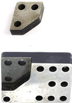
**Figura 1 – Modelo do canal em aço carbono, capaz de reproduzir uma curvatura com um ângulo de 45° e 5 mm de raio.**
